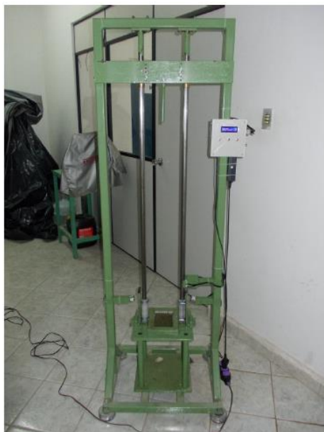
Figura 4.92 - Máquina de impacto por queda de peso desenvolvida na pesquisa.
