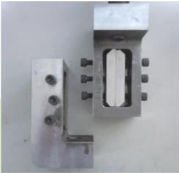
Figura 173 - dispositivo V-Notched Rail Shear fabricado na UFGM.
