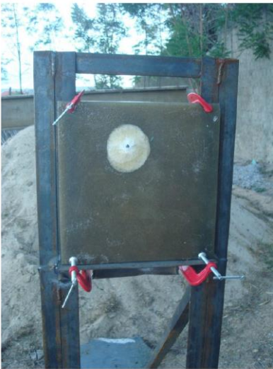
Figura 3.5 Esquema de fixação do alvo na estrutura
