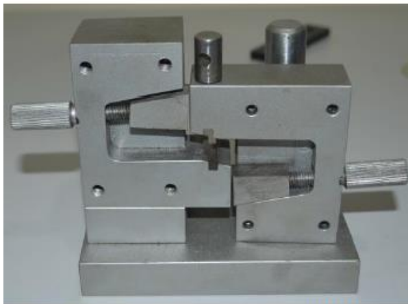
Figura 112 - Protótipo confeccionado para o ensaio ASTM 5379.
