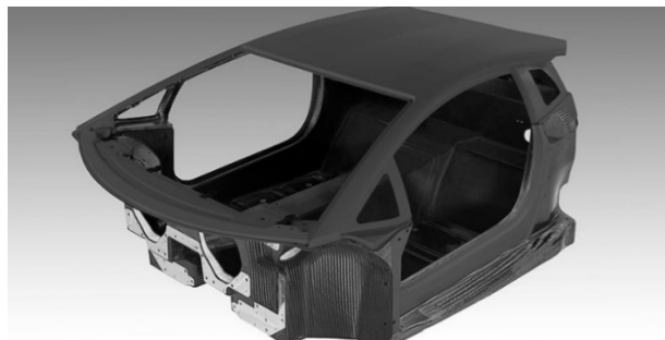
Figura 4 - Monocoque da Lamborghini Aventador LP 700-4.
