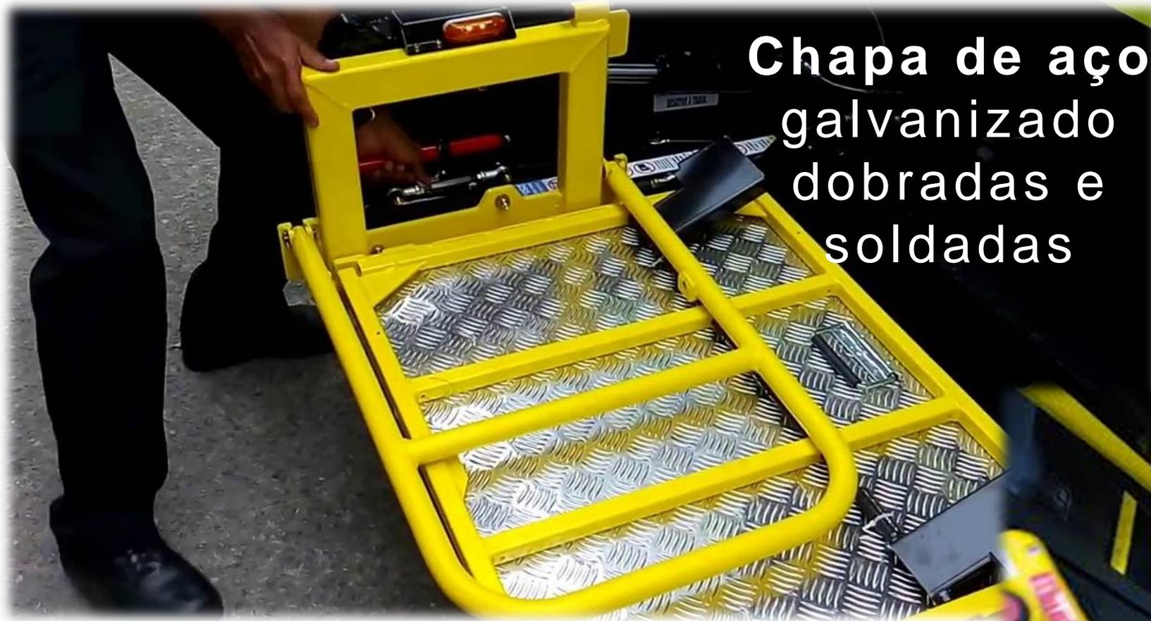
Chapa de aço galvanizado dobradas e soldadas
