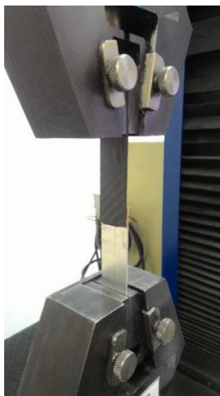
Figura 20 - Fotografia da máquina utilizada nos ensaios de cisalhamento de uma junção single lap de alumínio/compósito baseado em fibras de carbono.
