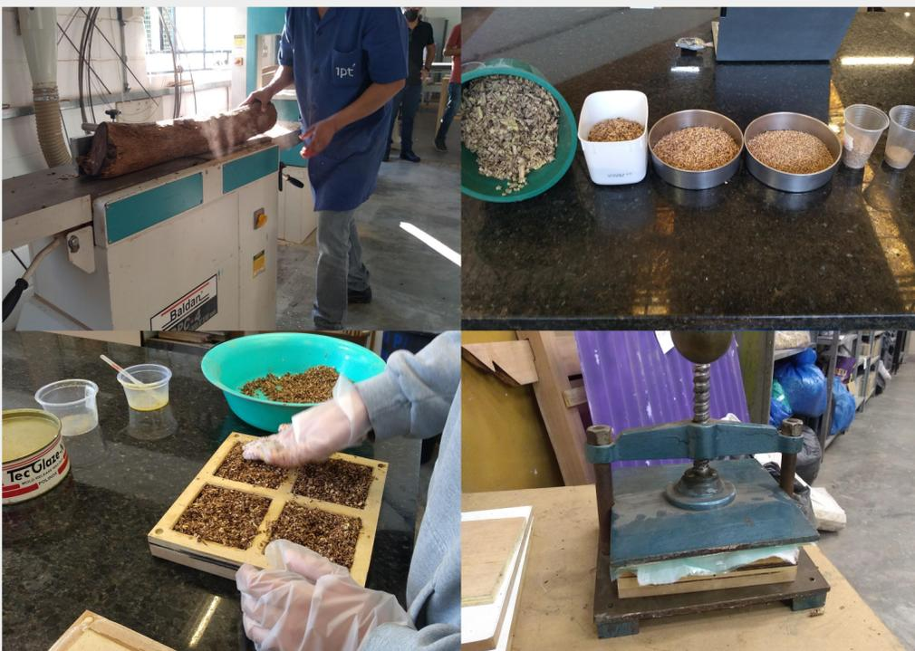
Desdobro de galhos de tipuana, separação de diferentes granulometrias da serragem gerada, moldagem da mistura de serragem e resina vegetal e prensagem do molde.
